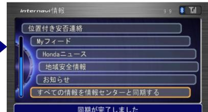
3 【同期が完了しました】と表示されたら、一度クルマのエンジンをきってください。再度エンジンをかけてカーナビを起動させたら設定完了です。
